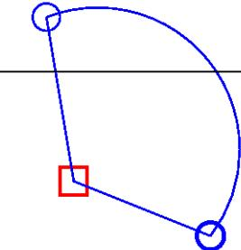
$$\begin{pmatrix} x' \\ y' \\ z' \end{pmatrix} = \begin{pmatrix} A_{11} & A_{12} & A_{13} \\ A_{21} & A_{22} & A_{23} \\ A_{31} & A_{32} & A_{33} \end{pmatrix} * \begin{pmatrix} x \\ y \\ z \end{pmatrix} - \begin{pmatrix} R_x \\ R_y \\ R_z \end{pmatrix} + \begin{pmatrix} t_1 \\ t_2 \\ t_3 \end{pmatrix} + \begin{pmatrix} R_x \\ R_y \\ R_z \end{pmatrix}$$
