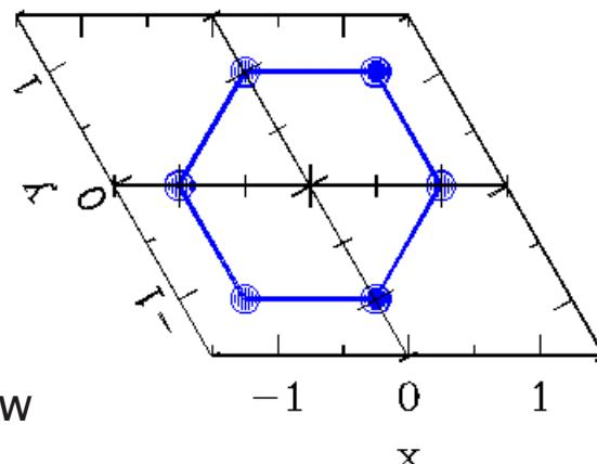
$$\begin{pmatrix} x \\ y \\ z \end{pmatrix} \rightarrow \begin{pmatrix} x-y \\ x \\ z \end{pmatrix}$$
